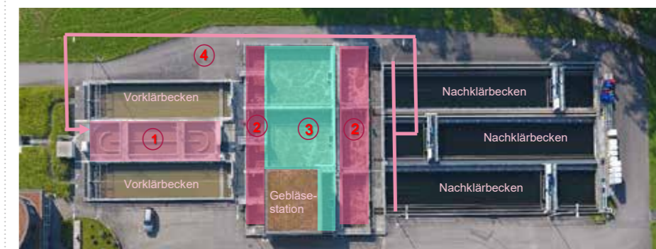
Die einzelnen Elemente der biologischen Stufe in der Abwasserstrasse: 1 Die Anoxzone als Belebtschlammssystem: Stickstoffabbau und Erhöhung der Alkalinität 2 Das belüftete Belebtschlammssystem: Kohlenstoffabbau (teilweise Stickstoffabbau) bei Schlammalter < 5 Tage 3 Das Hybridsystem: Belebtschlamm und Wirbelbett kombiniert: Nitrifikation auf Trägermaterial, Kohlenstoffabbau im Belebtschlamm 4 Rücklauf: Rücklauf Belebtschlamm, Nitrat und Restalkalinität
